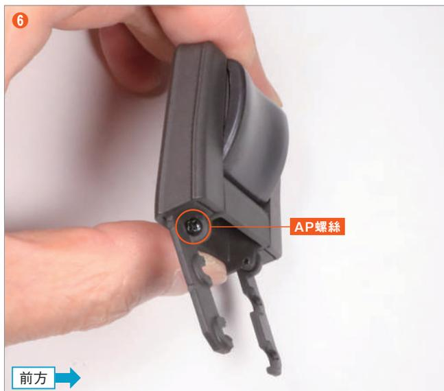
鎖緊 AP 螺絲 時, 要注意避免 60-E 螺絲孔裂開, 請將螺絲起子正對螺絲孔, 一點一點地小心鎖緊。如果 60-E 的螺絲孔不小心裂開或無法鎖緊, 也不必擔心, 因為後續步驟中會將整個座椅背架固定住。當 60-D 和 60-E 幾乎無法移動時, 停止鎖緊螺絲即可。
