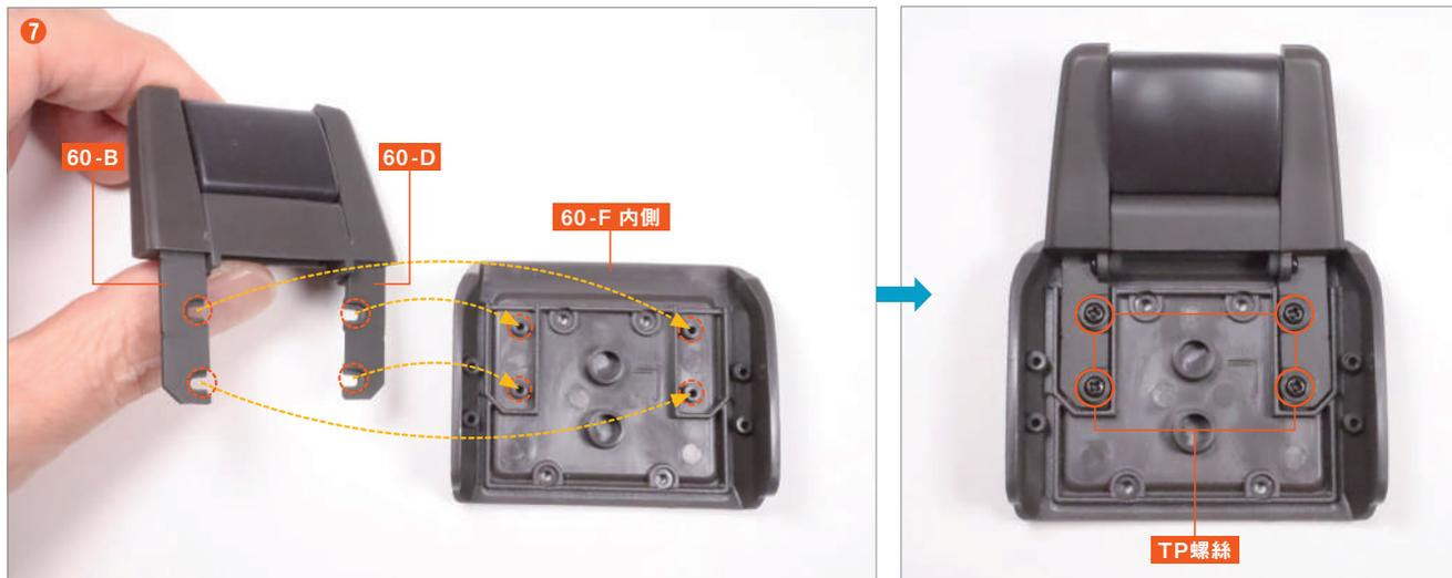
將 60-B 和 60-D 各自的兩個螺絲孔缺口與副駕駛座椅背護板 60-F 內側的四個螺絲孔對齊嵌入,然後使用 TP螺絲 將四個位置固定。
