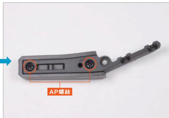
將座椅背架 (L) 60-B 的兩個圓形螺絲孔突起部分對準座椅背上墊 (L) 60-A 的兩個螺絲孔突起部分嵌入，並使用 AP 螺絲 兩個位置。
